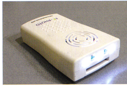
<図7>LEDライトの光量は焦点を確認するためには十分なものであり、補助光を必要としない。
